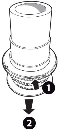
► Cuando esté previsto y resulte necesario desmontar el cesto, presione en la zona indicada para desenganchar el recipiente; luego extráigalo tirando de él hacia abajo.
