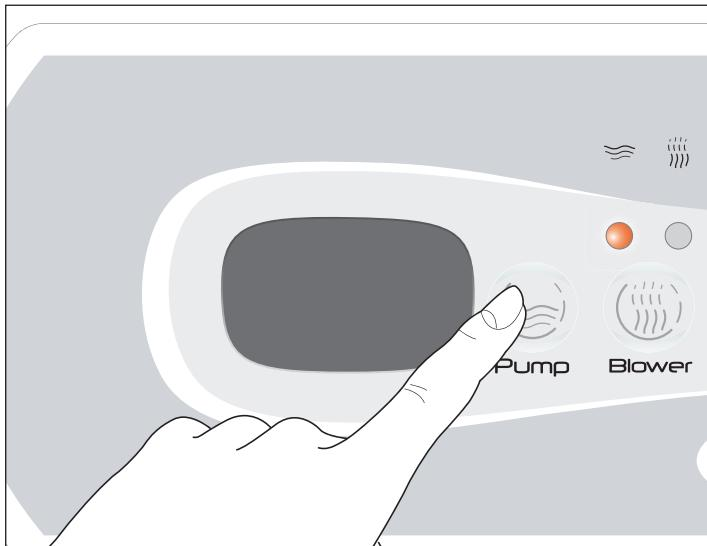
► Pulse una vez el botón “**Pump**” para poner en marcha la bomba a baja velocidad: se enciende el led correspondiente parpadeando. Púlselo de nuevo para pasar a la alta velocidad (led encendido con luz fija).
