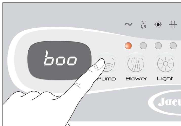
► Zum Aktivieren der Funktion, die Taste "Pump" (Pumpe) für etwa 5 Sekunden gedrückt halten: auf dem Display erscheint die Schrift **boo**.
